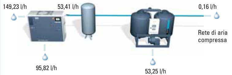
RISPARMIO ENERGETICO UTILIZZANDO SILICAGEL COME MATERIALE ESSICCANTE
